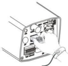
3. Подключите волоконно-оптический штекер и оптический модуль.
