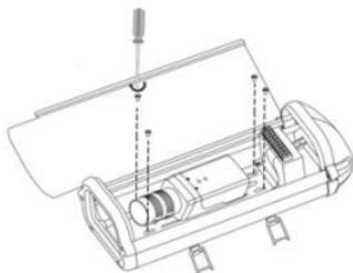
4. Прикрепите универсальное шарнирное соединение к задней панели корпуса.
