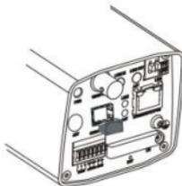
2. Вставьте оптический SFP-модуль, рекомендованный дилером.
